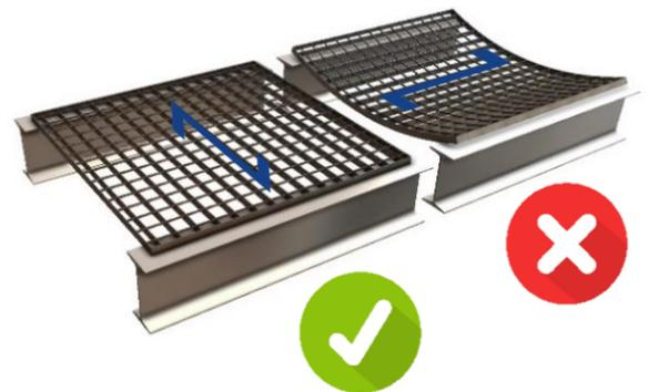
Maille et barre porteuse à déterminer en fonction de la charge admissible
