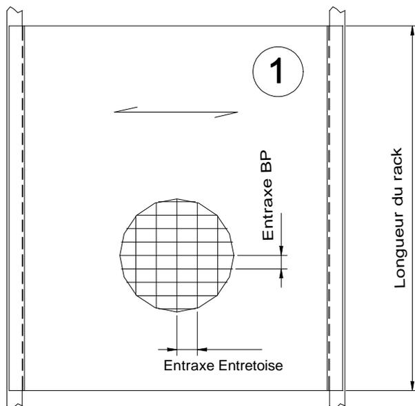
!!!! La maille et la barre porteuse sont à déterminer en fonction de la charge admissible !!!!
