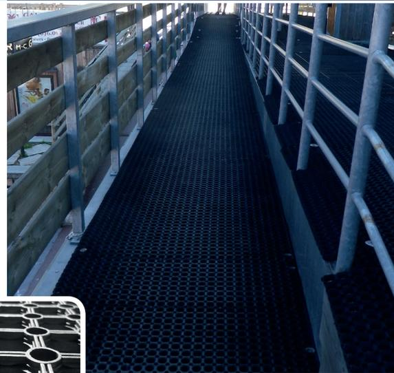
Les caillebotis caoutchouc sont directement posés sur le sol et n'ont pas besoin d'être jointés. Les eaux pluviales s'écoulent alors sous les dalles et sont récupérées par le biais des évacuations. Il s'installe facilement, ne nécessite aucune fixation particulière et peut se retirer en quelques instants. Les plaques se clipsent entre elles avec des attaches pour les relier et les maintenir. Nos caillebotis caoutchouc présentent de nombreux atouts :
