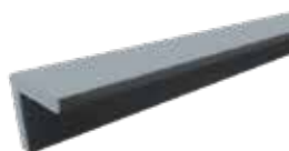
Cornière polyester Longueur standard : 3000 mm. Dimensions : 30 x 30 x 5 mm et 50 x 50 x 6 mm. Possibilité de mise à longueur. Disponible en stock.
